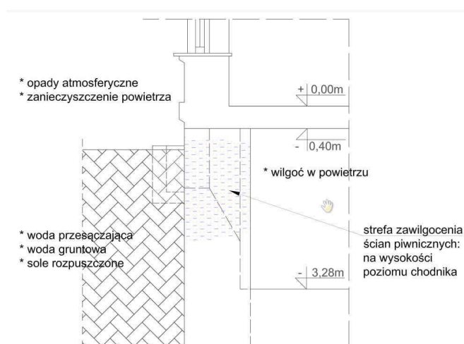
Szkic nr 2 Przekrój przez ścianę piwniczną z oznaczeniem strefy zawilgoconej (stan w m-cu lipcu 2018 r.)
